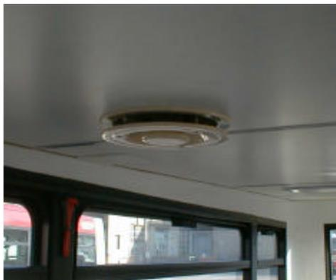
En la parte trasera del piso inferior del vehículo hay un sistema para recircular el aire interior compuesto por unos ventiladores que soplan aire (sobre la fila de asientos traseros y cubiertos por una rejilla) y dos aspiradores (ver foto), lo cual crea una pequeña corriente que renueva el aire de la zona.
