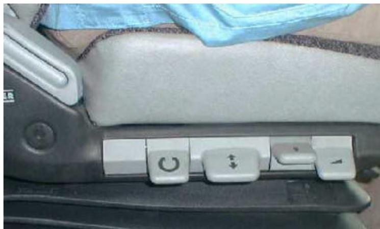
El asiento del conductor es de tipo neumático y permite gran cantidad de reglajes.
