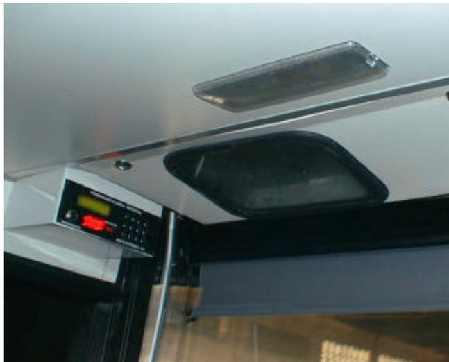
Delante del conductor existe una mirilla que en su interior contiene un juego de espejos y permite tener una visión del piso superior y de lo que en él ocurre. Puede ser muy útil para vigilar que alguien viaje de pie en lugares en los cuales puede resultar sumamente peligroso.
